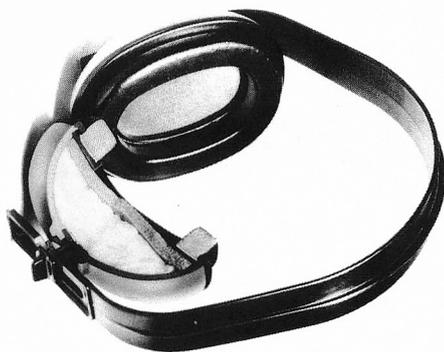
Gehörschutzkapsel, ähnlich wie ein Kopfhörer. Eine Seite ist aufgeschnitten. Beachte die verschiedenen Schichten zur Dämmung und Dämpfung des Schalls!
