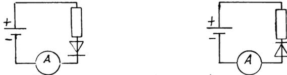
Ergebnis: Das Besondere bei einer Diode ist, daß sie eine Durchlaßrichtung und eine Sperrrichtung hat. Sie läßt den Strom nur in der Durchlaßrichtung durch.
