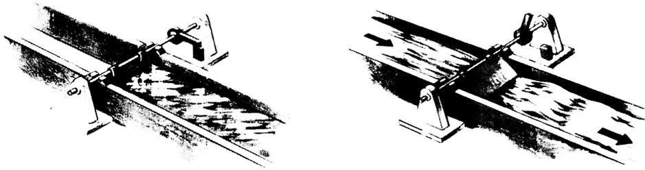
Wie funktioniert das abgebildete Schleusentor ("Wassermodell einer Diode" ?)
